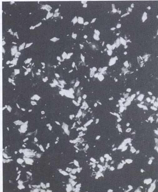
Das Bild links zeigt vergrößert die zusammenhängenden, großen Paraffinkristalle, die sich bei Frost im Dieseldieselkraftstoff bilden. Das rechte Bild zeigt einzelne kleine Paraffinkristalle. Die Bildung von großen Kristallverbindungen wird durch Fließverbesserer verhindert – der Kraftstoff bleibt filtergängig.
