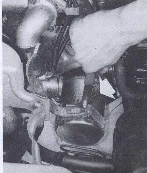
Lösen des Ölfilters mit einem Spannbandschlüssel: Links sehen Sie den Ölfilter des Benziners, rechts den des Diesels. Vorsicht, heißes Öl läuft aus!
