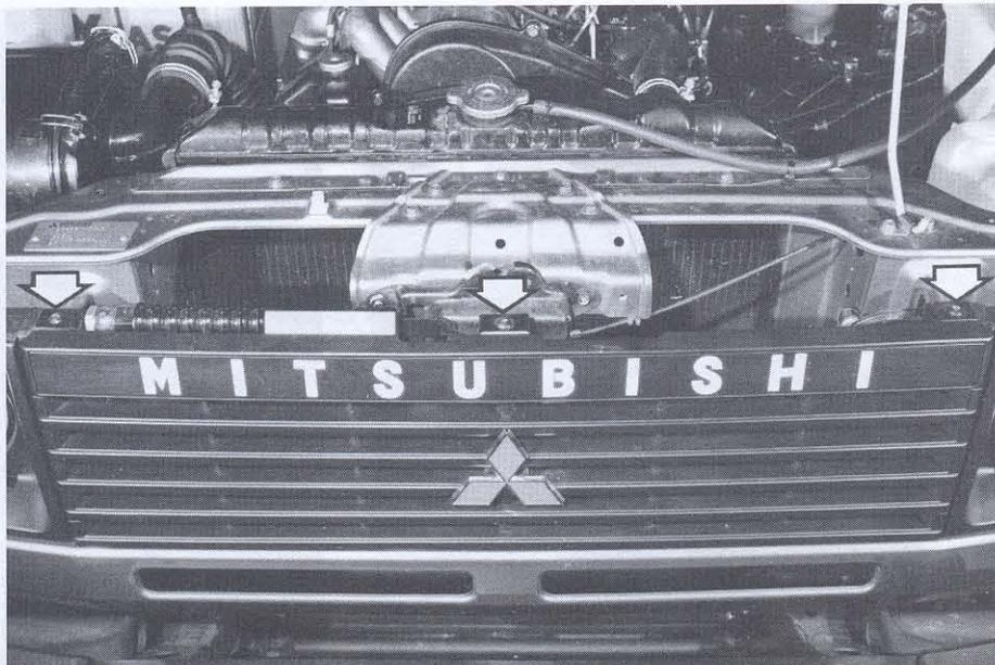
Mit insgesamt drei Kreuzschlitzschrauben ist der Kühlergrill an der Fahrzeugfront befestigt.
