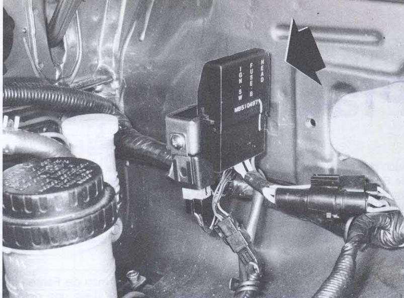
Kabelbränden durch ständig stromführende Kabel ausgeschlossen. Nach der Hauptsicherung gelangt der Strom entweder direkt oder über Umwege zu den weiteren Sicherungen des Fahrzeugs. In den Schaltplänen ab Seite 170 können Sie diese Wege verfolgen.
