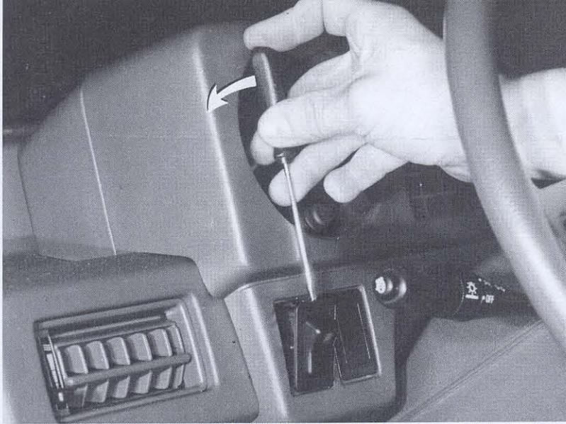
Hier ist der Ausbau eines Kippschalters gezeigt: Kleinen Schraubenzieher zwischen Schalter und Armaturenbrett einschieben. Schraubenzieher in Pfeilrichtung drücken und Schalter heraushebeln.
