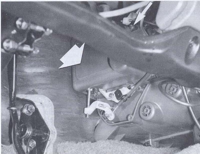
Hinter der Abdeckung liegt das Heizventil und der Wärmetauscher. Wo die Befestigungsschraube der Abdeckung sitzt zeigt der kleine Pfeil.
