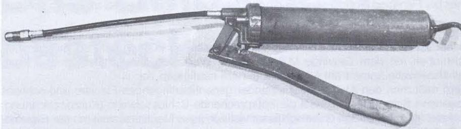
Für den der sein Fahrzeug selbst abschmieren möchte eignet sich am besten solch eine Handhebelpresse mit flexiblem Schlauch.
