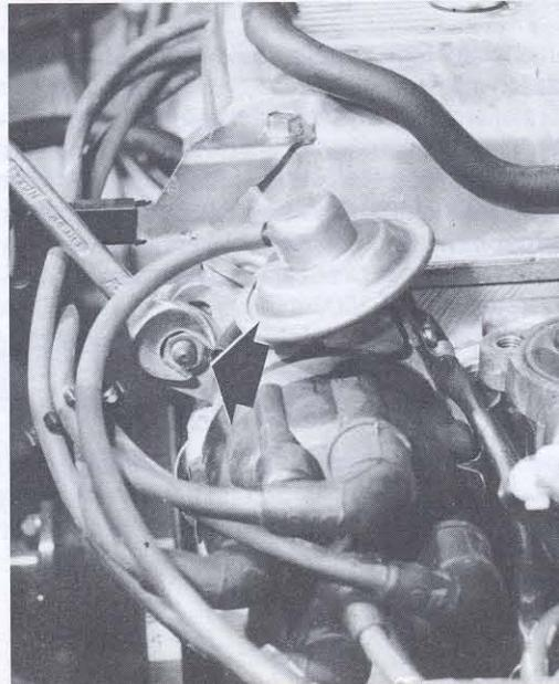
Links: Beim Prüfen des Zündzeitpunktes mit der Stroboskoplampe muß die Kerbe (1) an der Kurbelwellen-Riemenscheibe der entsprechenden Markierung auf dem Steuergehäusedeckel (2) gegenüberstehen, siehe Tabelle oben. Auf unserem Bild zeigt die Kerbe auf die »T«-Markierung. Rechts: Zur Zündeneinstellung wird die Halteschraube des Verteilers (Pfeil) etwas gelöst und der Verteiler entsprechend verdreht.
